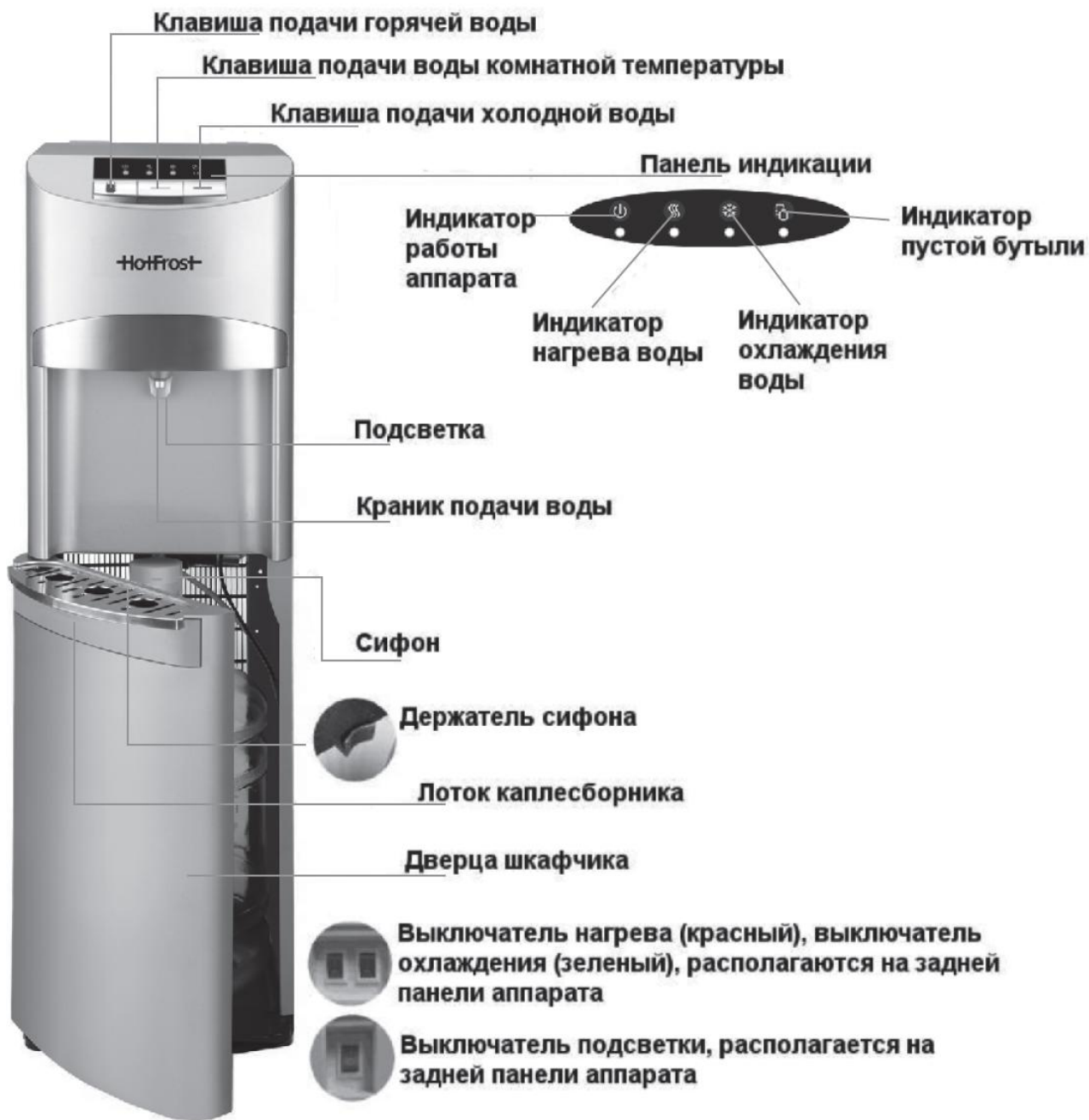
Рис.1 (б) Схема аппарата 35А (S,N)
